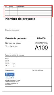
En todos los planos de Proyecto de Ejecución debe constar de un cajetín de revisiones, en el que se indique el número de revisión (RO1, RO2, RO3, etc.), una descripción del cambio ha habido en el plano y la fecha del cambio del plano. Se incorporará la tabla de revisiones en la cartela.
